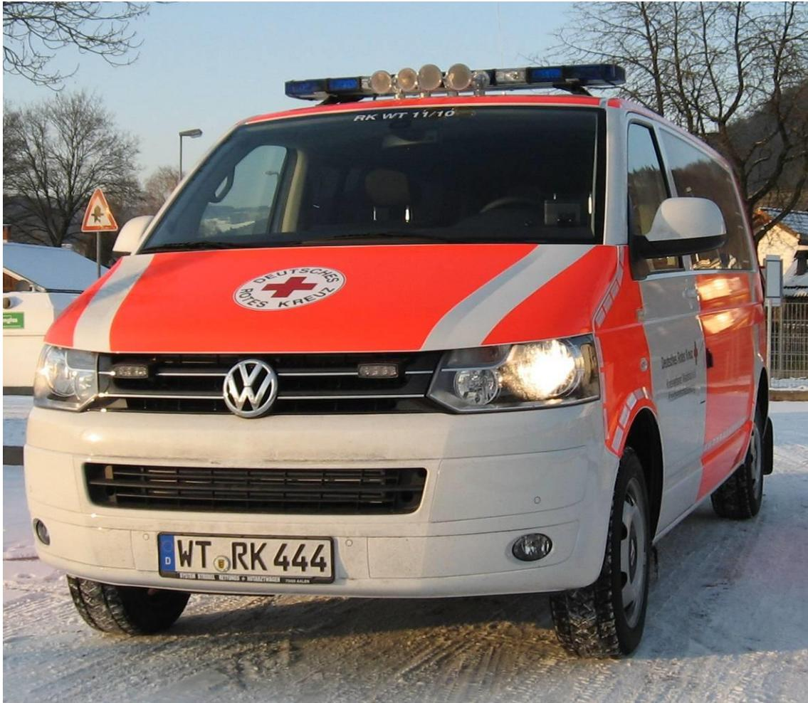
Auf dem Dach wurde ein Warnbalken von Whelen (Typ Liberty) mit blauen LED montieren. Im Warnbalken sind Halogen Arbeitsscheinwerfer nach vorne und nach rechts und links integriert.
