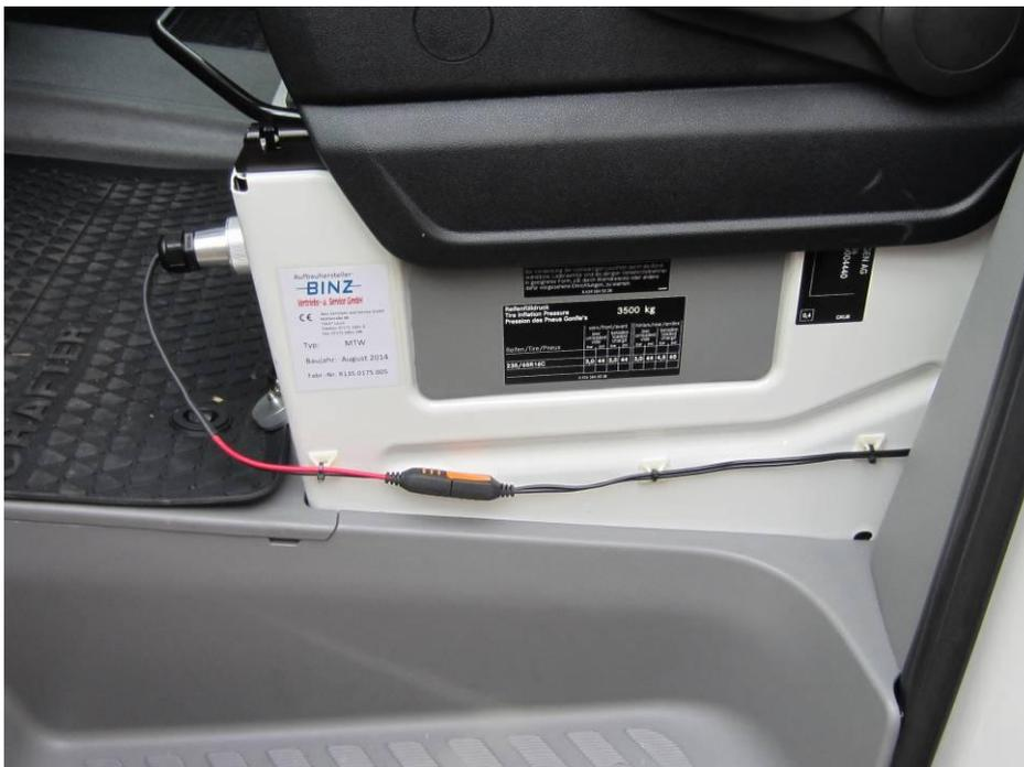
Anschluss Ladegerät, zur Unfallverhütung Kabel geklebt
