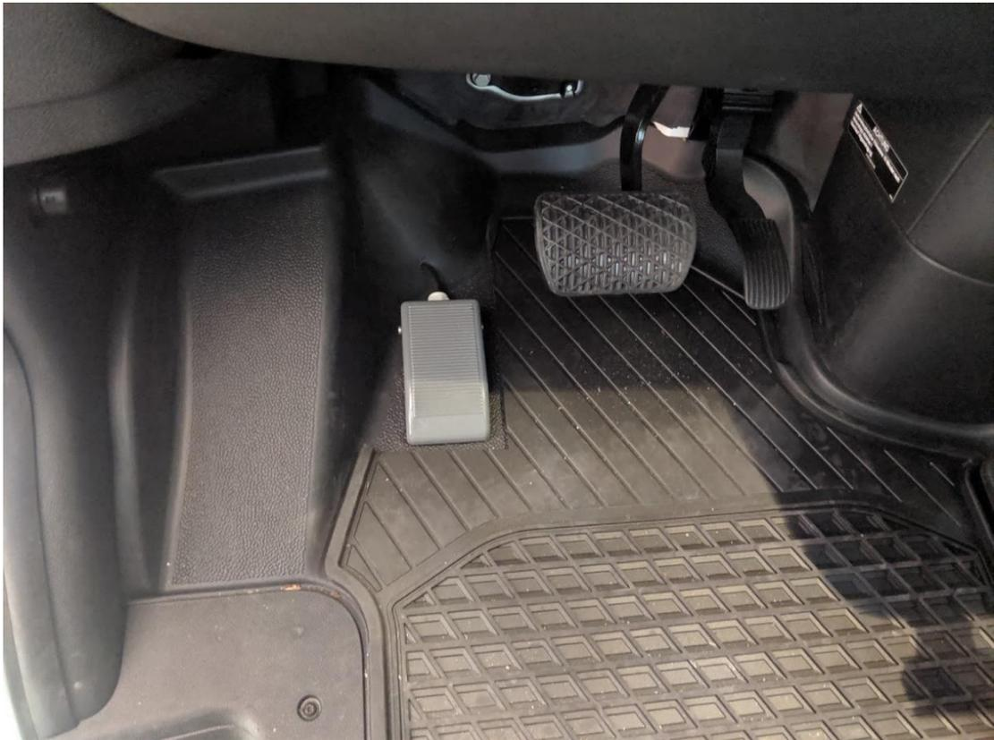
Der graue Schalter, links neben dem Bremspedal, ist der Fußschalter zum Betätigen vom Martin Pressluftthorns.
