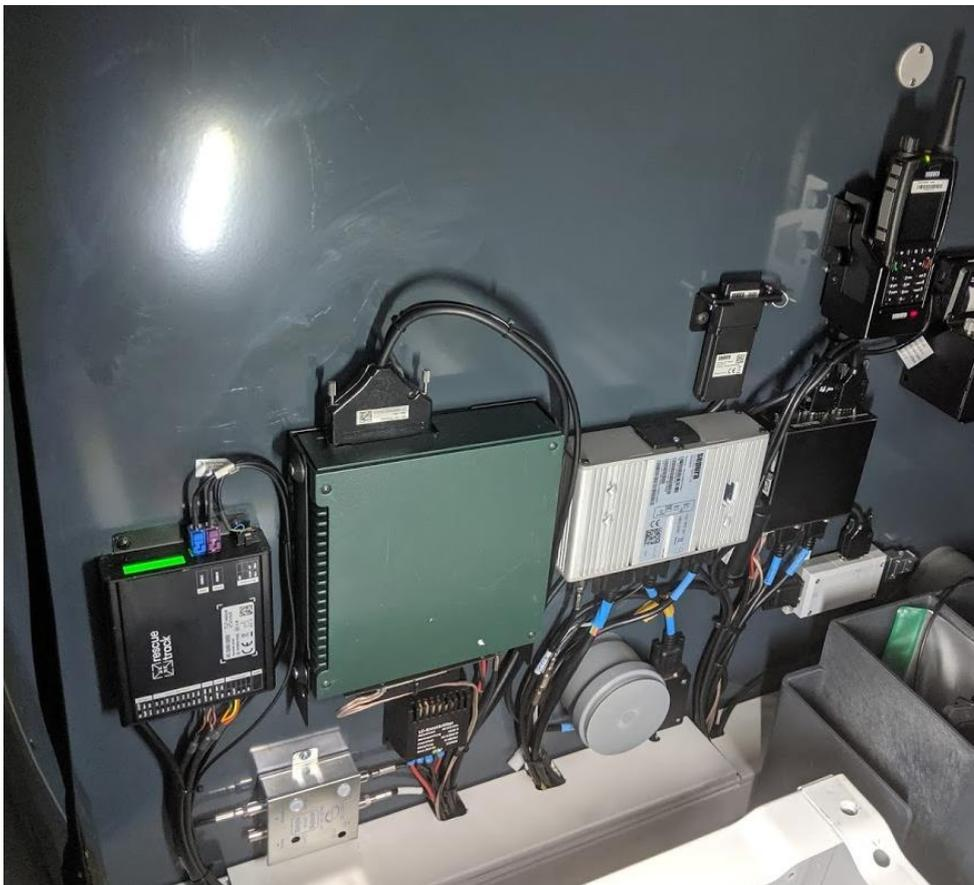
Geräte für Funk- und Datenübertragung an der Trennwand im Fahrerhaus
